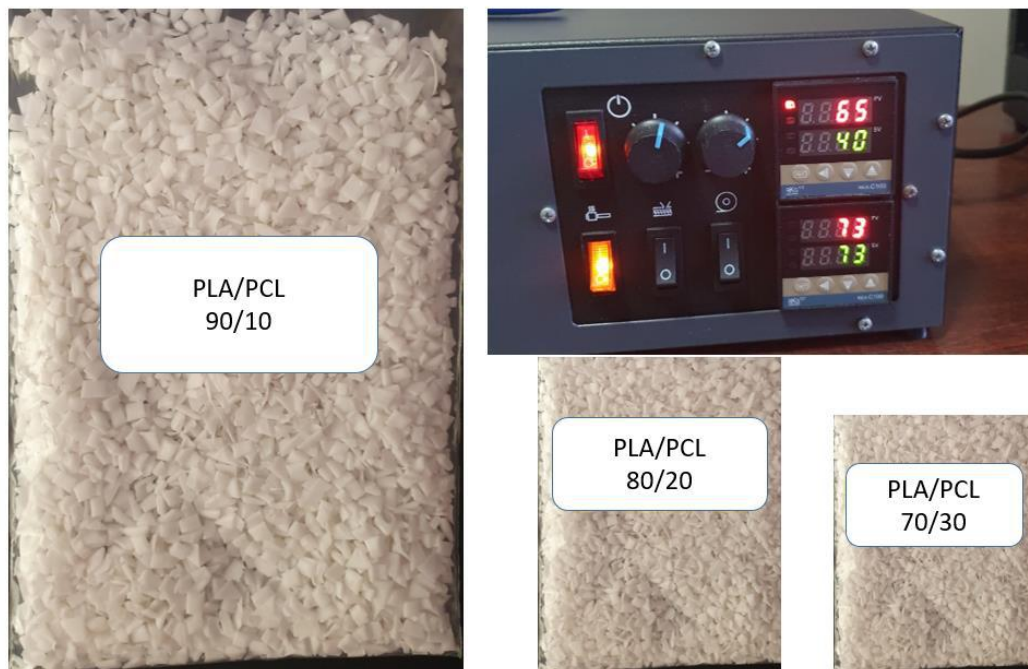
Рисунок 3.3 – Комбіновані матеріали PLA та PCL до екструзії
