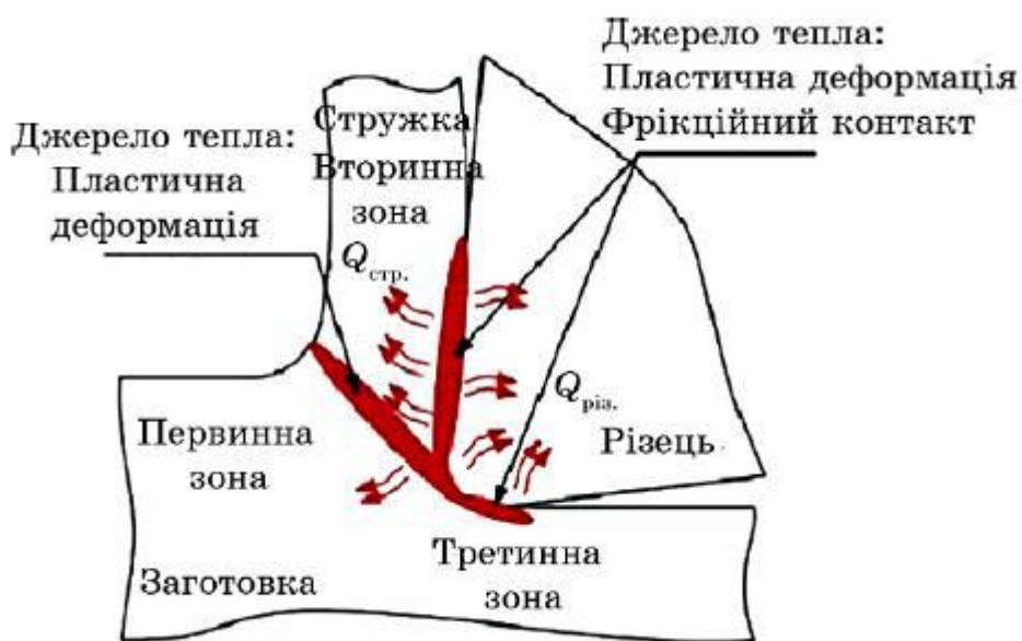
Рисунок 3 – Основні джерела тепла під час формування стружки при механічному обробленні [78]
