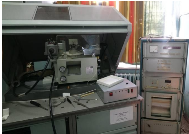
Рисунок 2.4 – Фото дифрактометру ДРОН-3
