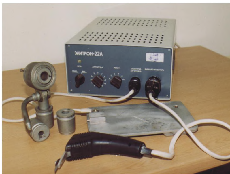
Рисунок 3.1 – Установа «Елітрон-22А» для проведення ЕІЛ
