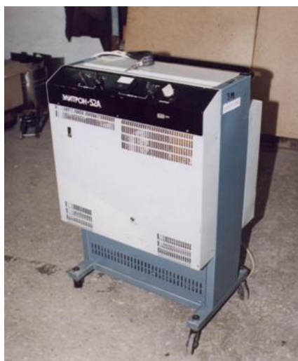
Рисунок 2.1 – Установка «Елітрон-52А» для проведення ЕІЛ
