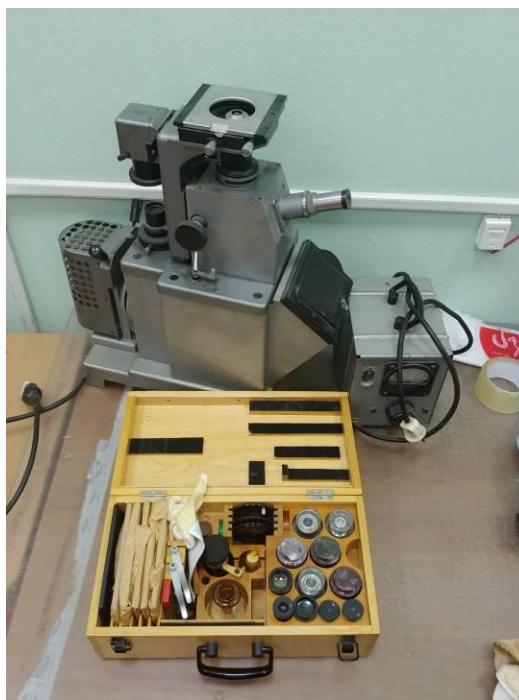
Рисунок 2.3 – Фото оптичного мікроскоп «МІМ-7» для проведення металографічних досліджень
