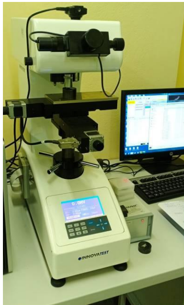
Рисунок 3.3 – Фото твердоміру NOVA 330/360
