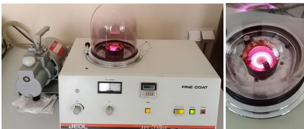
Рисунок 3.5 – Фото іонно-напилювального пристрою JFC-1100E
