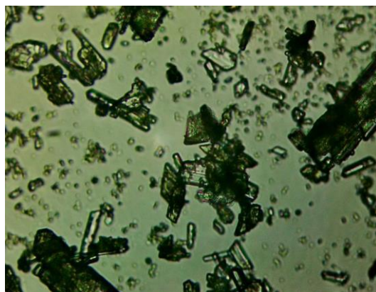
Рисунок 3.5 – Світлова мікроскопія фосфогіпсу в рідкій фазі за концентрації 5 грам на 200 мл трубопроводної води, збільшення 40х
