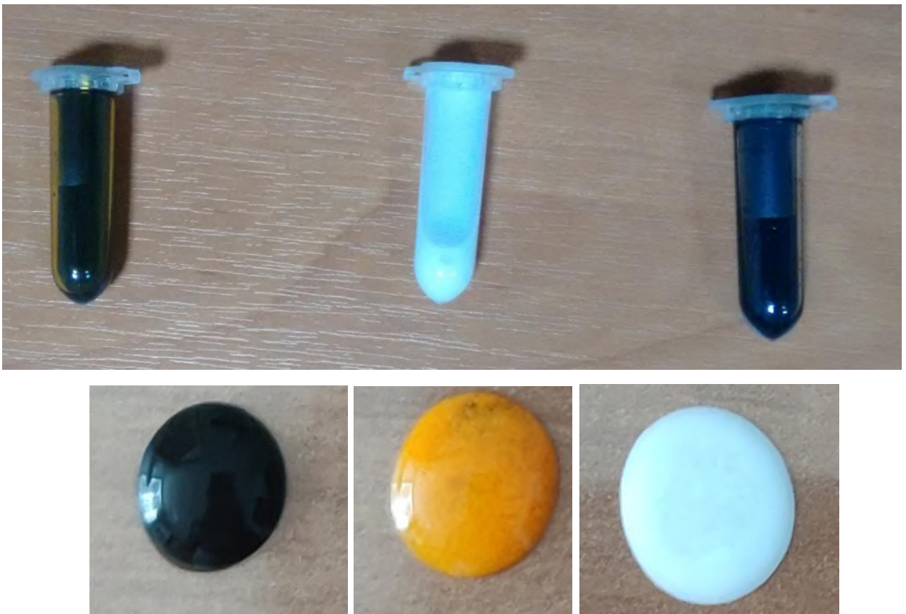
Рисунок 2.3 - Щойно синтезований розчин наночастинок \text{Cu}_2\text{ZnSnS}_4 , ZnO, \text{Cu}_2\text{ZnSnSe}_4 після заміщення поверхнево-активних речовин та краплі чорнил \text{Cu}_2\text{ZnSnS}_{4-y}\text{Se}_y , CdS, ZnO на підкладці
