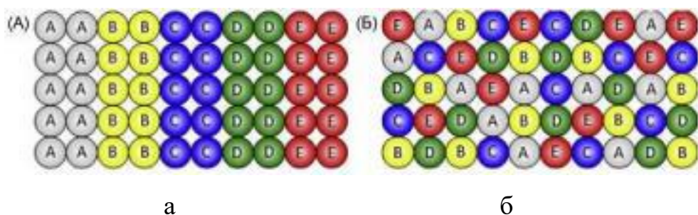
Рисунок 1.1 – Схематичне зображення розташування п'яти компонент у еквіатомному співвідношенні перед змішуванням (а) та після змішування з утворенням простого твердого розчину (б) [27]
