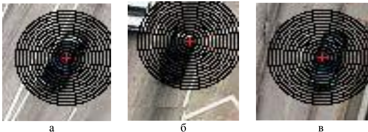
Рисунок 2.9 – Скриншот результатів визначення центрів системи полярних координат на автомобілях: а – клас X_1^o ; б – клас X_2^o ; в – клас X_3^o
