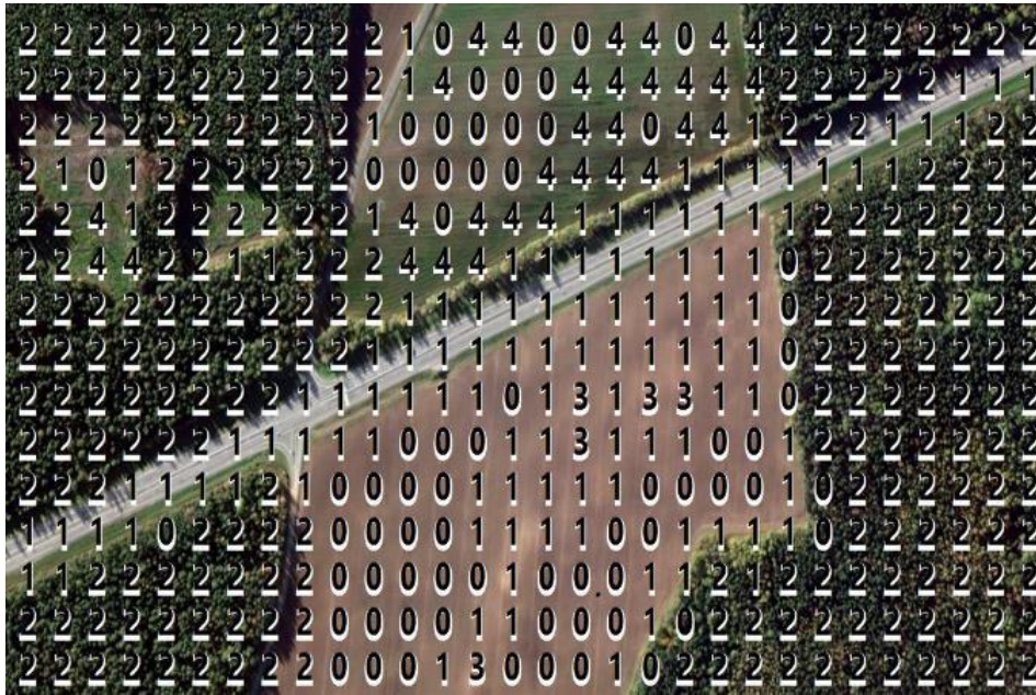
Рисунок 1.13 – Результат ідентифікації кадрів зображення регіону при початкових значеннях вагових коефіцієнтів RGB -складових зображень
