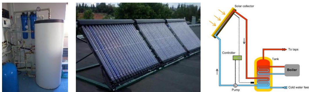
Мал. 18 – Система підігріву для підготовки гарячої води з використанням сонячної енергії
